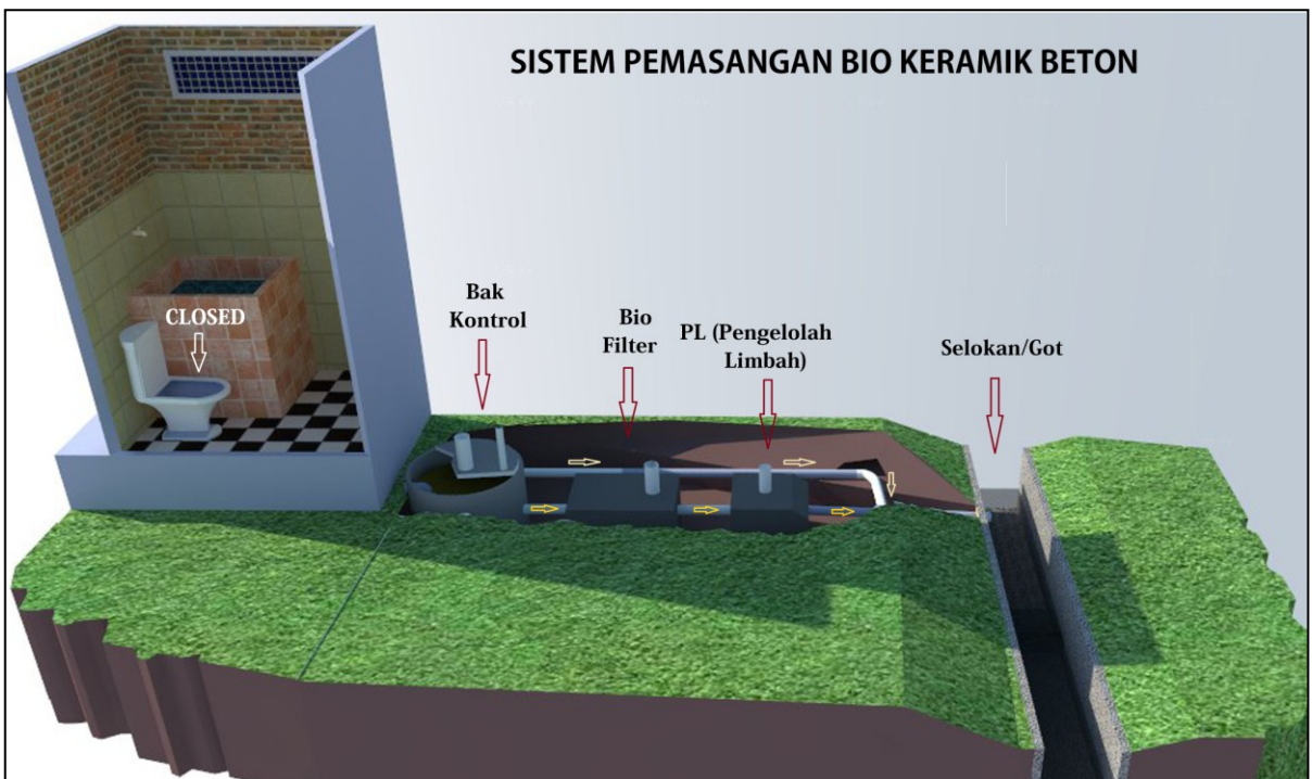
Gambar Petunjuk Tiknis Pemasangan BIO Filter
